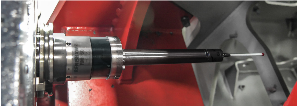
Renishaw RMP60M, szerszámgépeken használható tapintófej
