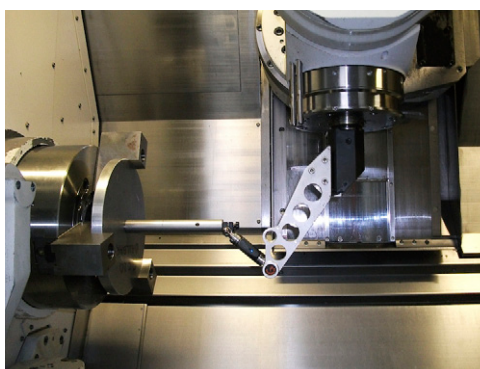
Systém QC20-W ballbar s lineárním snímačem při testování CNC soustruhu
