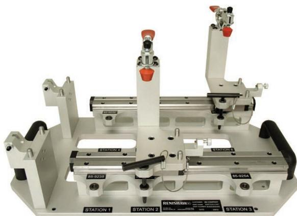
Linearführungen für mehrere Teile unterschiedlicher Länge.
