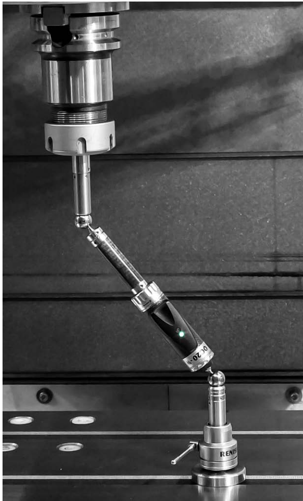
StankoMachComplex verwendet das QC20-W Kreisformmessgerät zur Überwachung des Werkzeugmaschinenzustands
