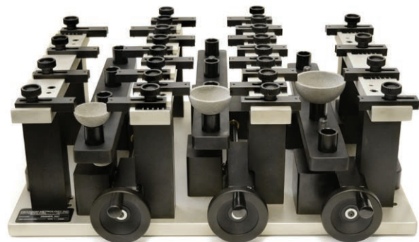
Fixação especial para fixar uma família de peças de vários tamanhos ao mesmo tempo.
