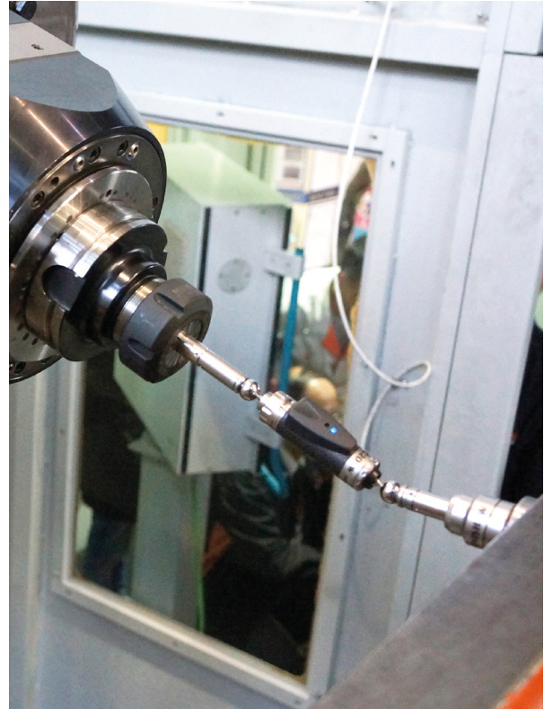
生產工具機時執行 QC20-W 循圓測試
