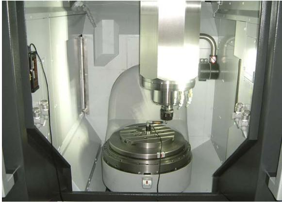
在NMV立式车削中心上运行球杆仪测试
