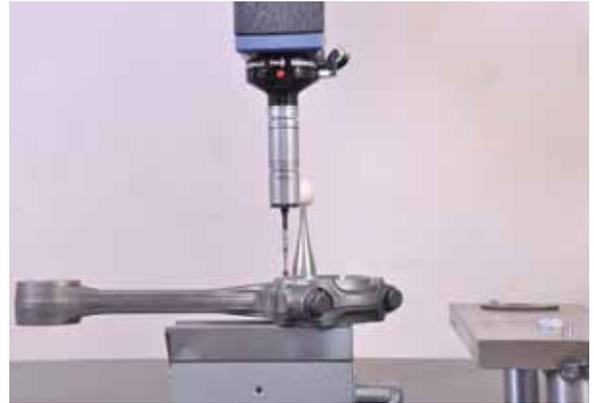
温控室内连杆标准件在坐标测量机上进行“标定”
