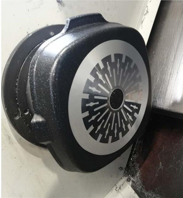
加工后的带不锈钢电磁感应片的铸铝锅体
