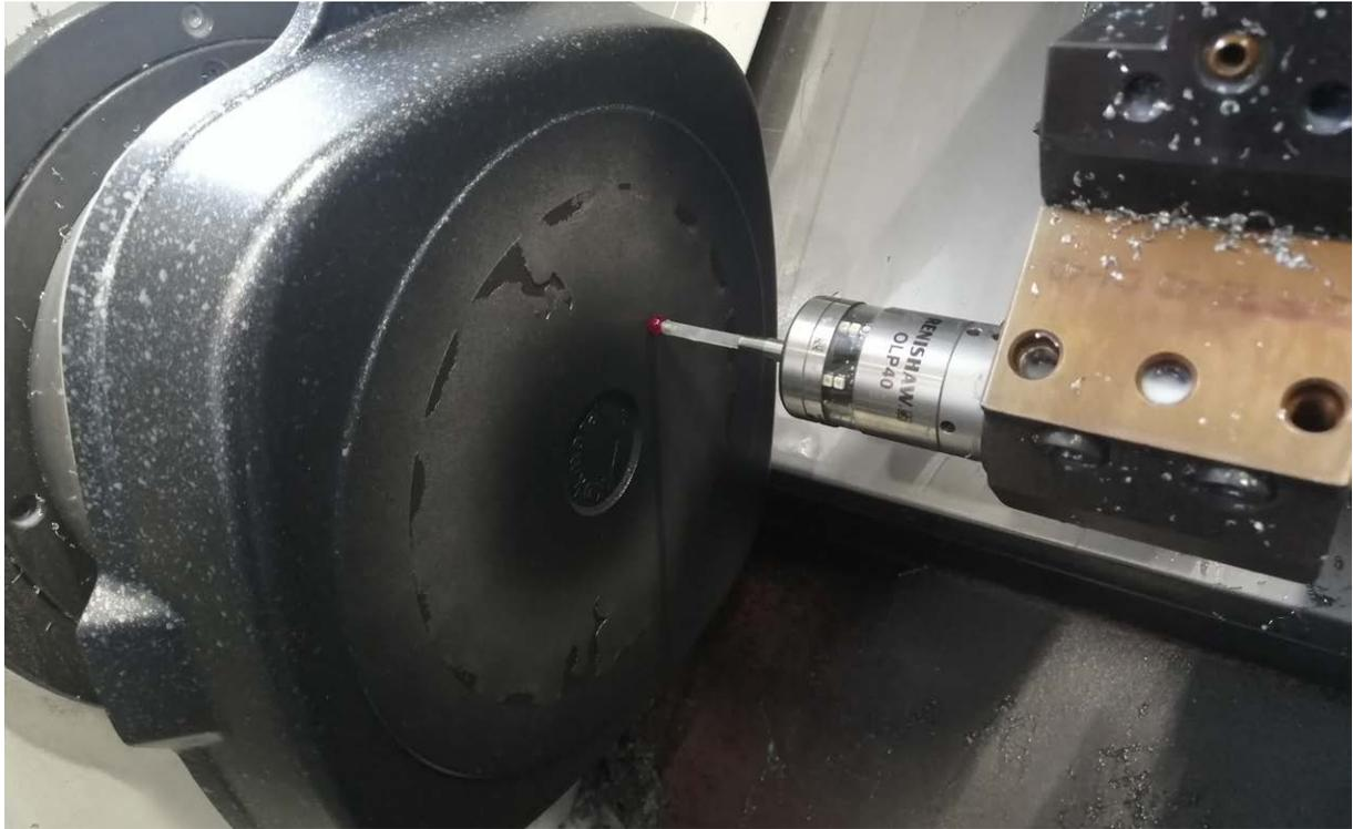
雷尼绍OLP40测头在加工前确定锅体的位置
