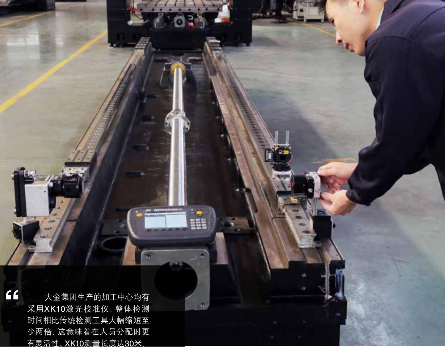
“大金集团生产的加工中心均有采用XK10激光校准仪，整体检测时间相比传统检测工具大幅缩短至少两倍。这意味着在人员分配时更有灵活性。XK10测量长度达30米，让我们很轻松的就可以完成行程的加工中心的直线度、平行度、垂直度、平面度等多个测量项目。
